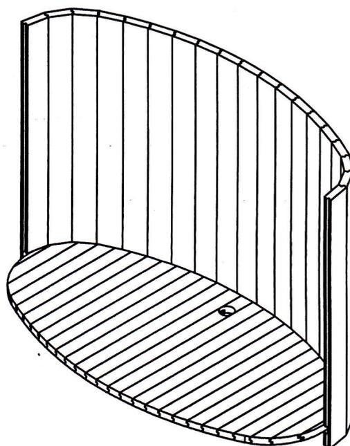
2. Последовательно соединять боковины с дном и между собой, ориентируясь на середину - "сливное отверстие", соблюдая метки на внутренней нижней части боковин.
