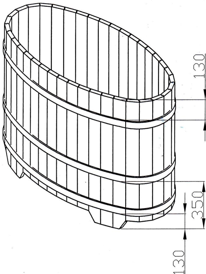
3. Установить обручи, соблюдая высоты как на рисунке. Крепления затяжки обруча располагать в доступных местах для последующих подтяжек. Затягивать обручи последовательно. Легкими ударами киянки с мягкой поверхностью простучать боковины со всех сторон. Затем еще раз подтянуть.
