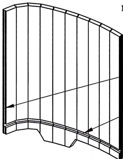
1. Расположить боковины на горизонтальной поверхности вогнутой стороной вверх и нанести в пазы слой герметика толщиной примерно 3-5мм. В местах стыка боковин между собой нанести ПУР-клей каплями с промежутками 50-70мм и затем растереть до получения равномерного слоя.
